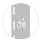
Radfahrstreifen oder Mehrzweckstreifen (Abschnitt eines Radfahrstreifens)
