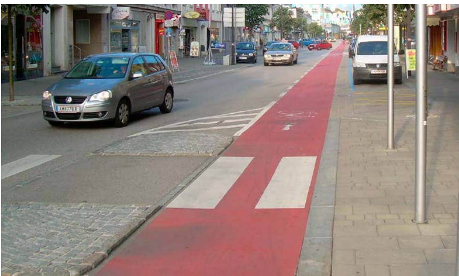
Bauliche Trennung der Fahrtrichtungen (im Bild vorne)
