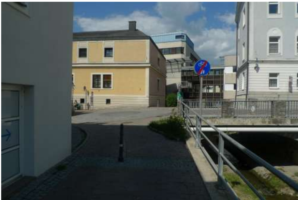
Abbildung 19: Die Kurve Doktor Strebl-Promenade / Hofkirchnergasse ist mit Poller, Randstein und Neigung nach außen recht gefährlich.
