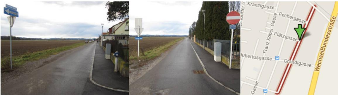
**Restfahrbahnbreite:** 2,70 m (von der Aspangerzeile bis zu Grandgasse), 3,10 m (ab Grandgasse bis Lachtengasse)
